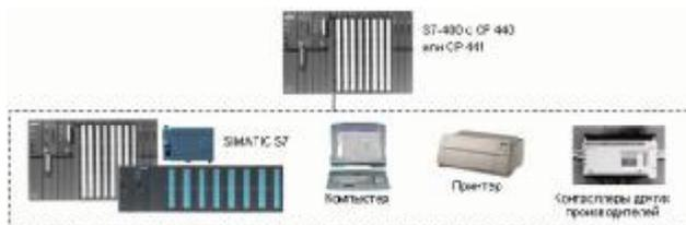
CP 340/CP 341 имеют по 3 модификации, отличающиеся типами встроенных последовательных интерфейсов. CP 440 оснащен встроенным интерфейсом RS 422/RS 485. CP 441-1 имеет один, а CP 441-2 – два гнезда для установки интерфейсных субмодулей IF 963 с различными типами последовательных интерфейсов. Каналы модуля CP 441-2 работают независимо друг от друга и могут использоваться с одинаковыми или различными интерфейсными субмодулями, одинаковыми или различными протоколами передачи данных и т.д.
