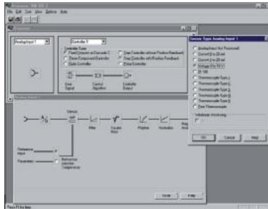
Для оптимизации работы регуляторов температуры, уровня, давления, потока может использоваться дополнительный пакет программ **PID Self-Tuner**. Пакет позволяет оптимизировать работу:
