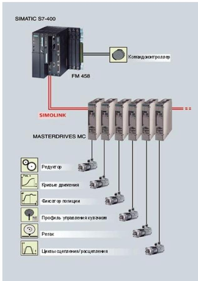
Стандартные разработки выполнены с использованием STEP 7 и CFC. Они предназначены для применения в технологическом модуле T400. Их можно также модифицировать и для использования в FM 458-1 DP. Для этого необходимо только настроить функциональные блоки для интерфейсов ввода/вывода и коммуникационного интерфейса.
