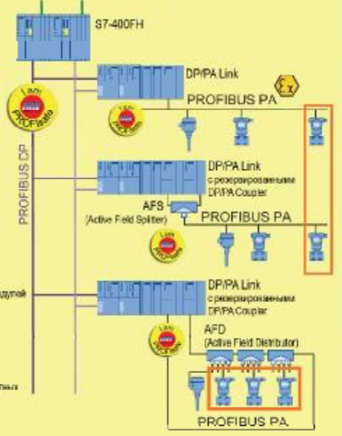
Гибкое модульное резервирование на уровне модулей или приборов
